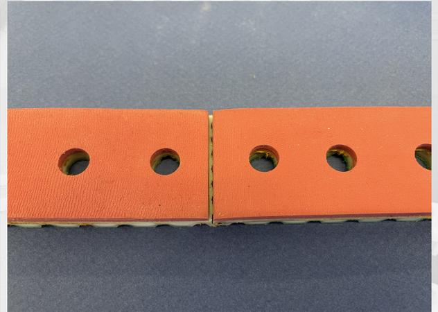
Vérifier que la tige ne dépasse pas des bords de la courroie ; Ne pas démonter la courroie (nous consulter si besoin) !
