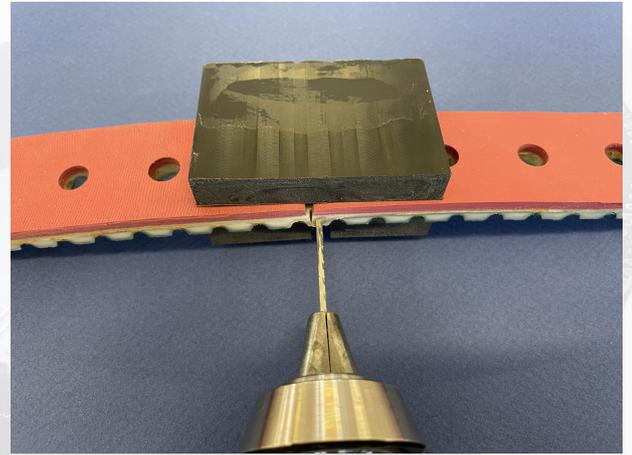
Après avoir mis la tige dans une visseuse en laissant dépasser la plus grande longueur possible, visser la tige en visant bien au milieu du trou en étant perpendiculaire à l'outillage, de façon à ne pas endommager les câbles.
