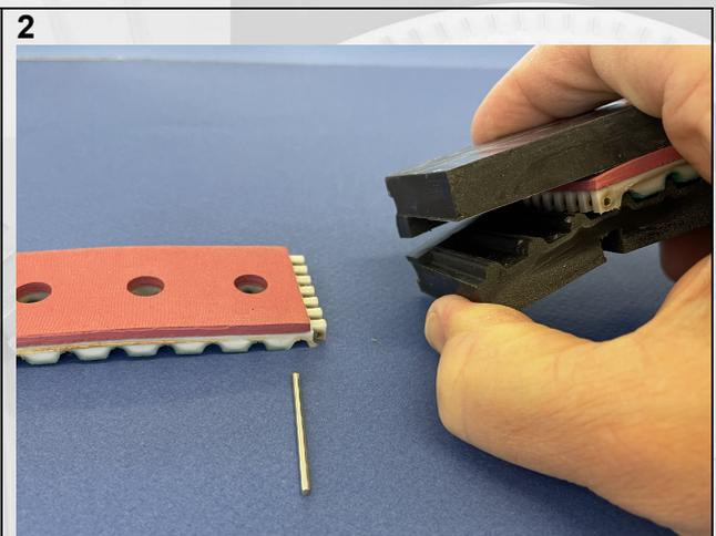
Avec la main droite vous pouvez écarter la partie basse de l'outillage pour enfiler la partie gauche de la courroie par la gauche (elle doit s'emboîter dans la partie droite déjà présente dans l'outillage).
